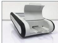
カートリッジを袋から取り出し、サンプル添加部を上向きにして機器前面にあるスロットに挿入します
